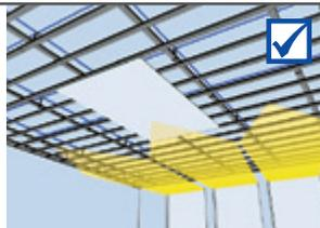
Pour le montage, utiliser un lève-plaques ou se faire aider par une seconde personne pour positionner correctement la plaque sur la sous-construction
