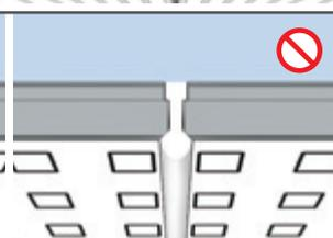
Avant la phase consolidante, voire avant le durcissement définitif du mastic, retirer le surplus de masse de jointoyage dans le sens de la longueur
