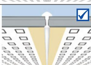
Les perforations bouchées par le mastic peuvent être rouvertes au moyen d'une roue à perforer.
