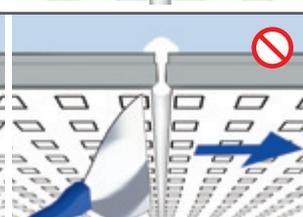
Joints et têtes de vis sont ensuite recouverts de mastic ou de matériau de finition. Auparavant, masquer et protéger les rangées de perforations longeant le joint avec du ruban adhésif.
