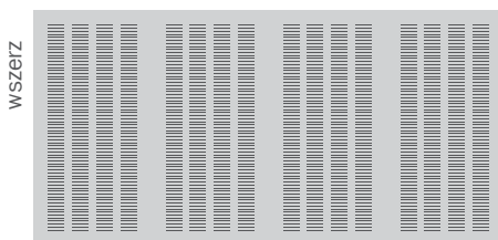
Perforacja szczelinowa w blokach 4F wzdłuż
