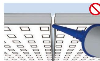
Para lograr una alta resistencia de las juntas, debe de poder formarse un «hongo» entre los dos paneles (véase la ilustración).
