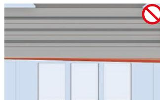
Los conectores longitudinales siempre se deben aplicar desfasados (véase la ilustración)
