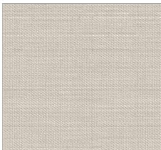
Bewertete Schallabsorptionsgrade  $\alpha_w$  von 0,5 (MH) - 0,8 (H) (ohne ergänzende Dämmschicht)
