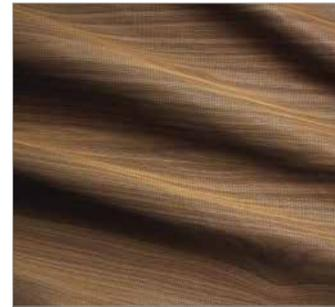
Bewertete Schallabsorptionsgrade  $\alpha_w$  von 0,60 (LM) - 0,70 (M)
