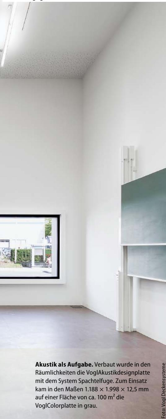
**Akustik als Aufgabe.** Verbaut wurde in den Räumlichkeiten die VoglAkustikdesignplatte mit dem System Spachtelfuge. Zum Einsatz kam in den Maßen  $1.188 \times 1.998 \times 12,5$  mm auf einer Fläche von ca.  $100 \text{ m}^2$  die VoglColorplatte in grau.
