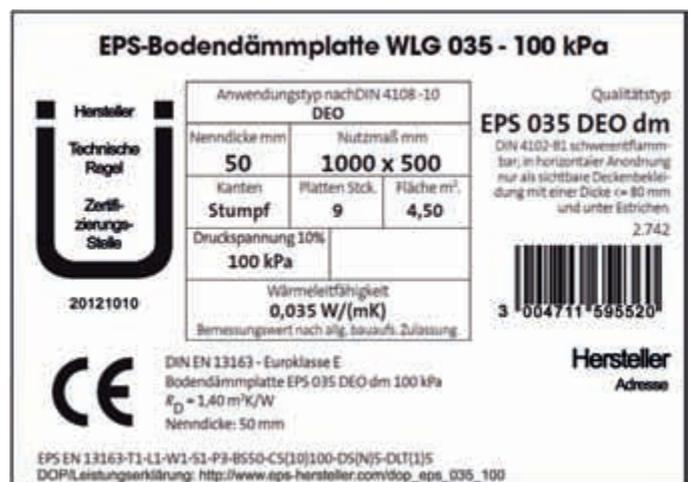
Abb. 05 Beispiel der Kennzeichnung von EPS-Dämmstoff
