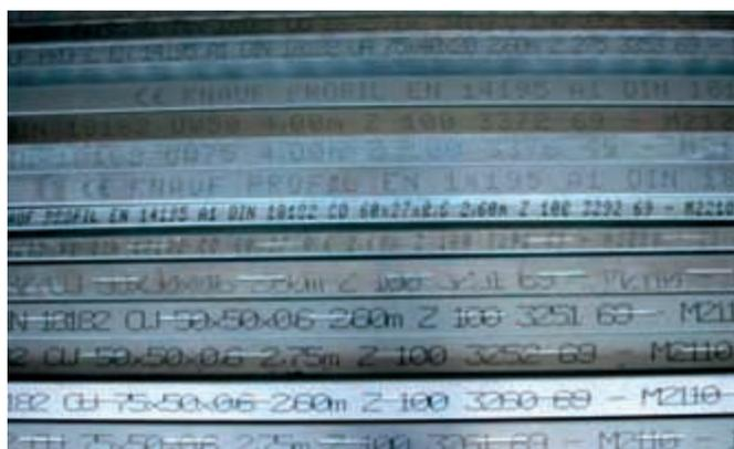
Abb. 11 Kennzeichnung von Profilen
