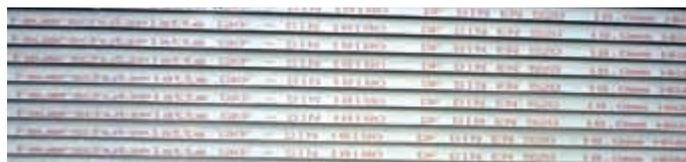
Abb. 02 Kennzeichnung von Gipsbauplatten
