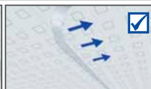
Contrôler la surface et les bords, il ne doit pas y avoir d'adhésif sur le côté visible du voile non-tissé (marques claires)
