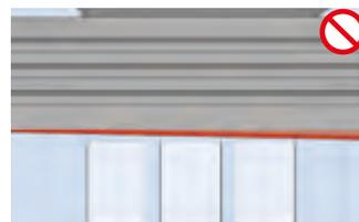
Puis, contrôler les écartements des profilés de plafond CD et réajuster le cas échéant. Les raccords longitudinaux doivent toujours être montés en quinconce (cf. illustration). Mesurer correctement les écartements !
