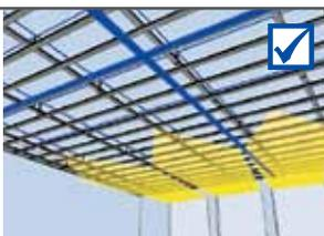
Sia per il montaggio individuale mediante sollevatore di lastre sia per quello con l'aiuto di altre persone, assicurarsi che il pannello venga fissato alla sottostruttura nella posizione giusta
