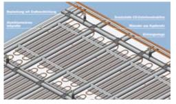
Variabel. Das Deckensystem kann als reine Klimadecke installiert werden, ebenso wie als Akustikklimadecke oder Akustikputzklimadecke.
