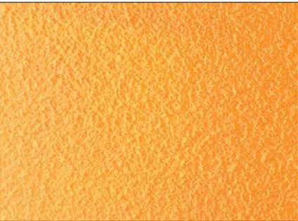
Dieses Akustikputzsystem wurde nach den Bedürfnissen des Anwenders entwickelt. Die Akustikputzdecken haben einen systemgeprüften Schallabsorptionsgrad von bis zu  $\alpha_w = 0,95$  (Absorberklasse A) bei einem Lochflächenanteil von 35 Prozent und lassen eine große Gestaltungsfreiheit mit konkaven und konvexen Formen zu.
