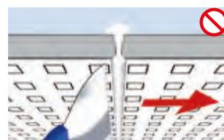
Joints et têtes de vis sont ensuite recouverts de mastic ou de matériau de finition. Auparavant, masquer et protéger les rangées de perforations longeant le joint avec du ruban à maroufler.
