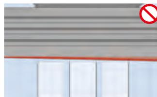
Les raccords longitudinaux doivent toujours être montés en quinconce (cf. illustration) Contrôler ensuite les écartements des profilés de plafond CD et réajuster le cas échéant. Mesurer correctement les écartements !
