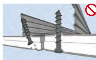
Écartement maximal des vis 170 mm d'un point de fixation à l'autre. Écart maximal entre la vis et le bord extérieur de la plaque 26 mm. Éviter d'endommager la plaque acoustique design avec les têtes fraisées des vis.
