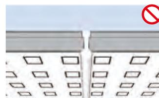
Avant la phase de consolidation, voire avant le durcissement définitif du mastic, retirer le surplus de masse de jointoyage dans le sens de la longueur.
