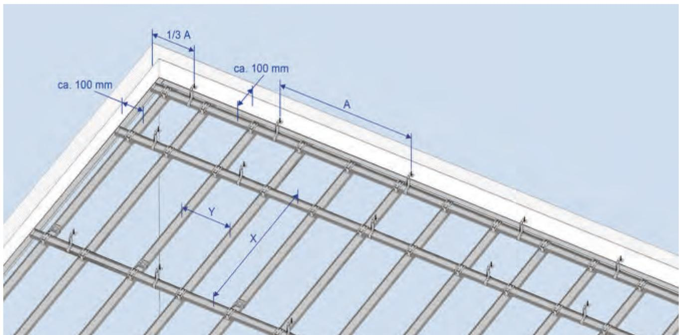
Die Prüfung unseres Deckensystems erfolgte nach DIN 18032-3: 1997-04 „Sporthallen, Hallen für Turnen und Spielen und Mehrzwecknutzung, Prüfung der Ballwurfsicherheit“ sowie EN 13964: 2007-02, Anhang D „Unterdecken: Anforderungen und Prüfverfahren, Stoßfestigkeit“.
