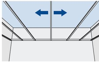
Nach dem Abschluss der UK-Montage die gesamte Deckenfläche kontrollieren, damit die Tragprofile passend ausgerichtet sind. Die Schnellspannhänger so justieren, dass diese stramm sitzen und die Konstruktion planeben ist.
