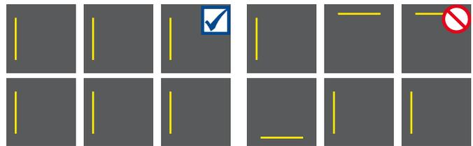
Kassetten nun in die T-Profile einsetzen, je nach Kantenart entsprechende Besonderheiten beachten. Während der Montagearbeiten immer saubere Handschuhe tragen.
