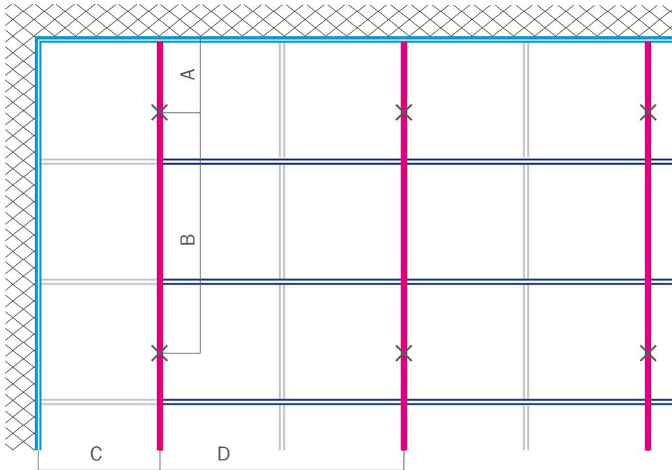
A = Max. 400 mm    B = Max. 1200/1250 mm    C = Max. 600/625 mm    D = 600/1200 mm bzw. 625/1250 mm
