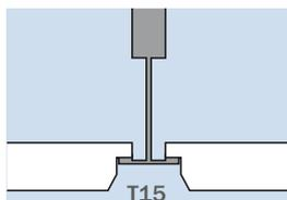
Vogl Kassetten sind revisionierbare, schalltechnisch hochwirksame gelochte Deckenplatten zum Einbau in T-Tragschienensysteme.
