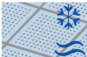
Die oberflächenfertigen Einlegekassetten bestehen aus werkseitig komplett vorgefertigten gelochten Gipsplatten-Kassetten, in welche die Kapillarrohrmatten zwischen den Lochreihen auf der Rückseite unsichtbar integriert sind.
