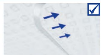
Contrôler la surface et les bords, il ne doit pas y avoir d'adhésif sur le côté visible du voile non-tissé (marques claires).
