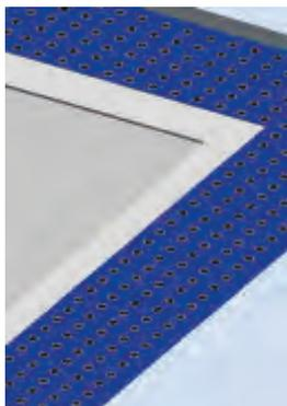
Les plaques du système de crépi acoustique VoglToptec sont des plaques perforées à insonorisation haute performance (exception : le type Reflexio conçu pour obtenir des zones réfléchissantes) servant à l'habillage du voile non-tissé support de crépi sur le chantier (non-tissé en fibres de verre) puis à l'application de la couche de finition au moyen du crépi acoustique VoglToptec.
