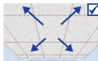
Poser le reste des plaques de plafond bord à bord en contrôlant en permanence la planéité des zones de jointure et en travaillant exclusivement selon le système de « joints croisés ».
