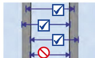
Vu de l'entrée, il est recommandé de disposer le bord court des plaques parallèlement aux fenêtres (orientation principale de la lumière).
