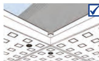
Une fois le montage des plaques achevé, contrôler à nouveau la planéité de toutes les zones de jointure, si nécessaire rectifier les différences de hauteur au tourne-vis. Terminer par un contrôle au moyen du niveau.
