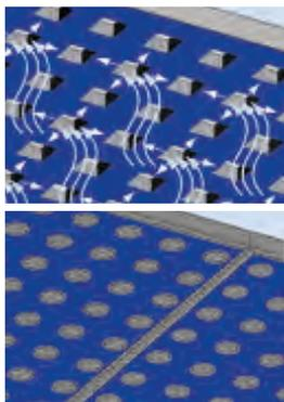
Les plaques acoustiques design du système Chanfrein Visible sont des plaques de plafond perforées à insonorisation haute performance et effet de purification de l'air (absorption).
