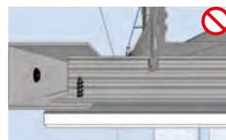
Prévoir un joint de dilatation de 5 à 10 mm à intervalles de 15 m crt/150 m<sup>2</sup>.
