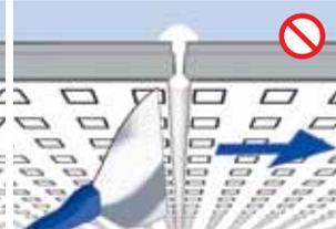
Giunti e teste delle viti verranno successivamente trattati con stucco o materiale di finitura; in precedenza coprire le serie di fori attaccate al giunto
