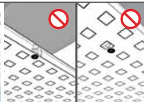
Avvitare il centro del pannello alla struttura, quindi calare il sollevatore di lastre. Successivamente fissare una vite al centro di ogni lato corto, di seguito avvitare il lato lungo alla struttura di sospensione
