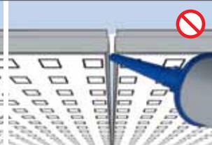
Per garantire un'elevata resistenza dei giunti, deve potersi formare un "fungo" tra i due pannelli (vedere figura).
