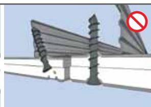
Le viti devono essere posizionate a una distanza massima di 170 mm dal punto di fissaggio e di 26 mm dal bordo esterno del pannello. Cercare di non danneggiare i pannelli acustici di design con l'applicazione delle viti.
