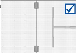
Avvitare le viti della zona di giuntura a due a due ("a zig zag"), iniziare da sinistra o da destra accanto alla vite di fissaggio preventivamente inserita. In questo modo si creano giunture planari
