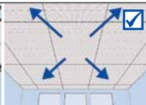
Posare i rimanenti pannelli per controsoffitto; lavorare sempre con 2 ausili di montaggio (eccetto foratura sparsa) e prestare attenzione al corretto posizionamento dell'ausilio di montaggio. Posare i pannelli solo nel sistema di "giunti incrociati" e controllare sempre visivamente la configurazione dei fori (diritto e in diagonale)
