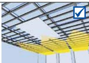
Sia per il montaggio individuale mediante sollevatore di lastre sia per quello con l'aiuto di altre persone, assicurarsi che il pannello venga fissato alla sottostruttura nella posizione giusta
