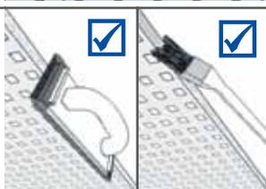
Per il montaggio si consiglia di utilizzare i seguenti accessori: viti per pannelli forati, incluso bit per avvitamento, kit di montaggio Vogl, Vogl Supergrund LF
