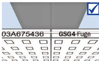
El siguiente panel de cielorraso se monta junta contra junta respecto del primer panel.
