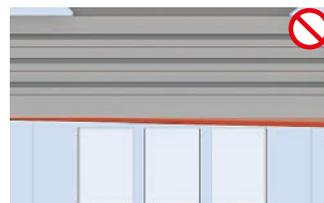
A continuación se deben controlar las distancias entre ejes de perfiles de cielorraso CD y, si es necesario, reajustarlas. Los conectores longitudinales siempre se deben aplicar desfasados (véase la ilustración). Medir correctamente las distancias entre ejes.
