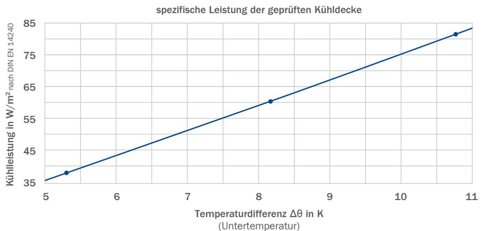
**VoglThermotop, gelocht, Lochbild 12/25Q, geprüft mit RiLO-Register CU50-GK**
