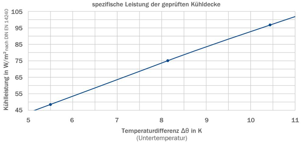
**VoglThermotop PLUS, gelocht, Lochbild 12/25Q, geprüft mit RiLO-Register CU50-GK**
