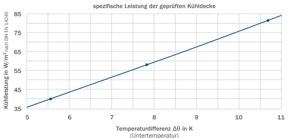
**VoglThermotop PLUS, glatt, geprüft mit RiLO-Register CU50-GK**
